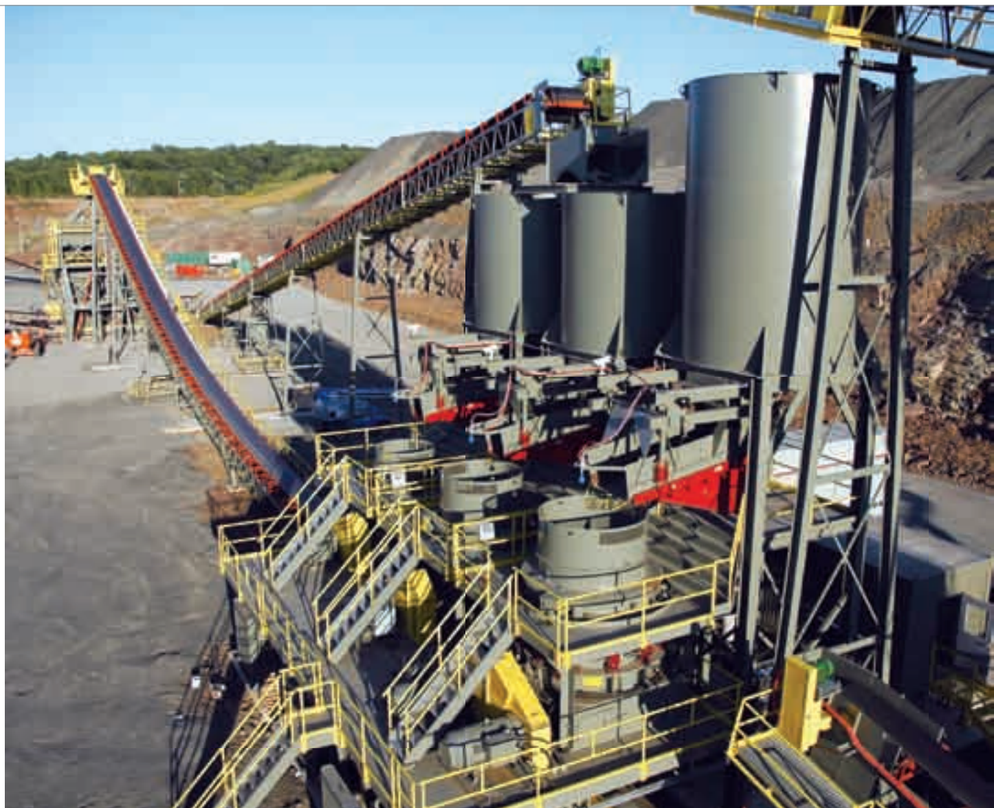
Planta trituradora automatizada de 1000 TPH con trituradoras de cono 68SBS, 57SBS y 52SBS
